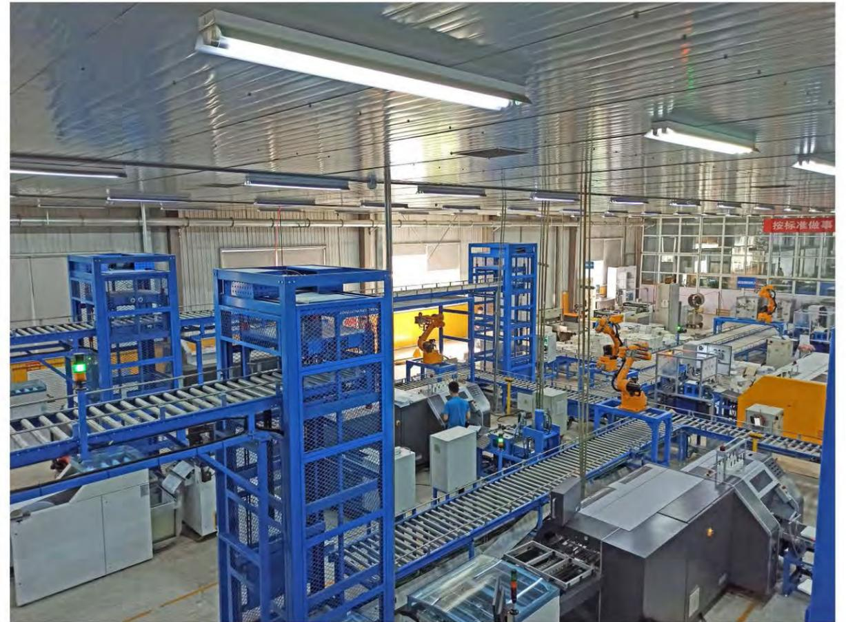
为印刷行业打造整厂自动化仓配一体化方案：以各生产线为核心，打造各类型中心仓，可分为原材料仓、辅料仓及成品仓，配合空中物流线，到达各个生产线位置。
